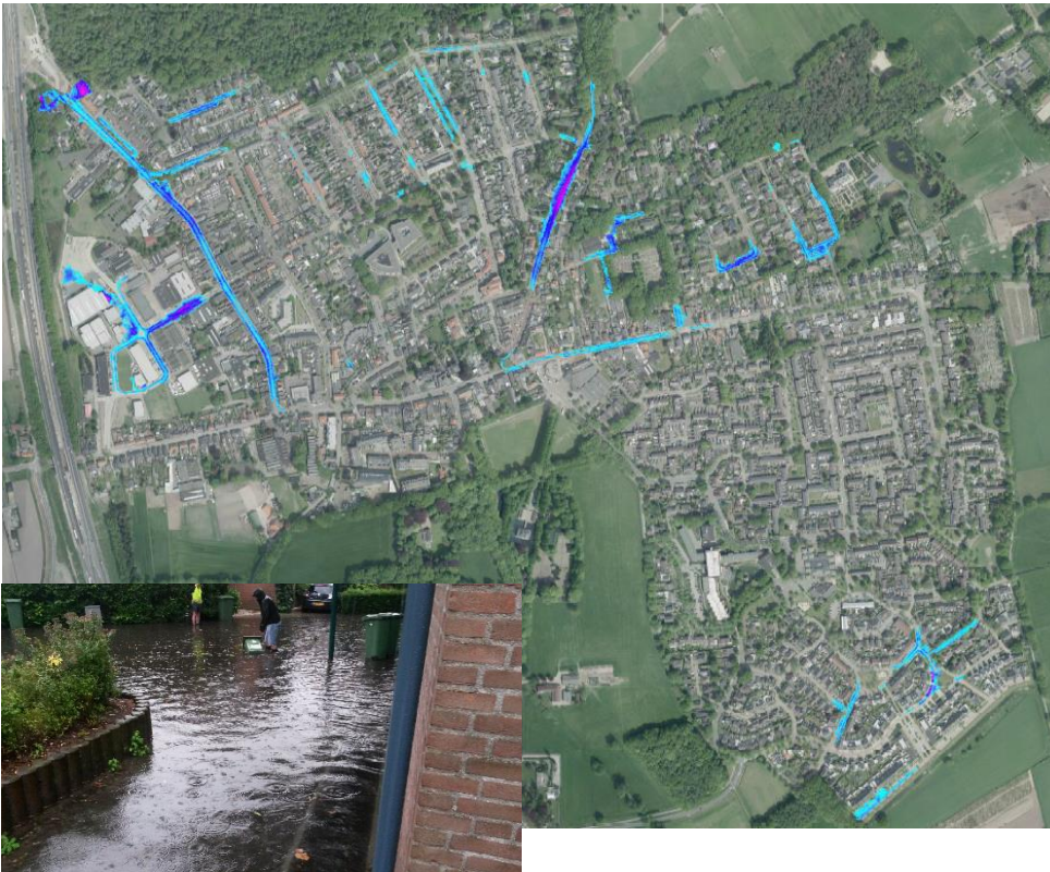
Afbeelding 13 Theoretisch berekende water op straat situatie kern Loon op Zand (bui 8 Leidraad Riolering). Inzet: wateroverlast Ecliptica in juli 2014.
