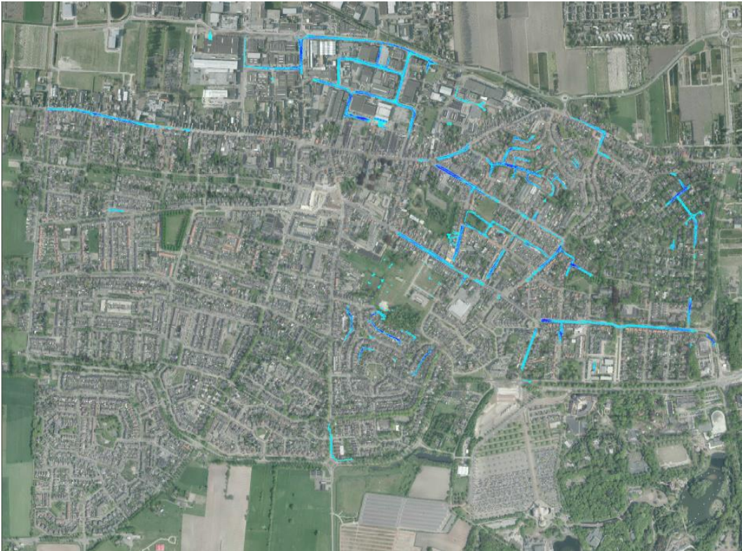
Afbeelding 11 Theoretisch berekende water op straat situatie kern Kaatsheuvel (bui 8 Leidraad Riolering).
