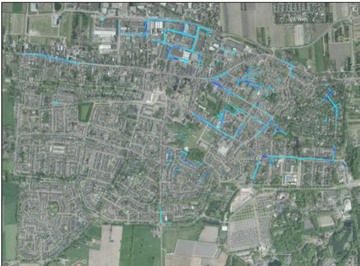
Figuur 5: Theoretisch berekende water op straat situatie kern Kaatsheuvel (bui 8 Kennisbank Stedelijk Water)
