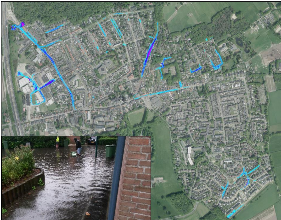
Figuur 4: Theoretisch berekende water op straat situatie kern Loon op Zand (bui 8 Kennisbank Stedelijk Water). Inzetafbeelding: wateroverlast Ecliptica in juli 2014.
